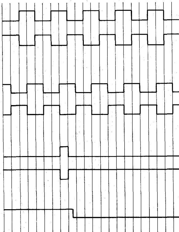
Mit Hilfe der inversen Signale  $\overline{U_{a1}}$ ,  $\overline{U_{a2}}$  und  $\overline{U_{a0}}$  lassen sich Störimpulse, die in die Leitung zwischen EXE und Folge-Elektronik induziert werden, eliminieren. Dazu ist die Eingangsstufe der Folge-Elektronik mit einem Differenzleitungs-empfänger aufzubauen (siehe Schaltungsvorschlag Pkt. 7).
